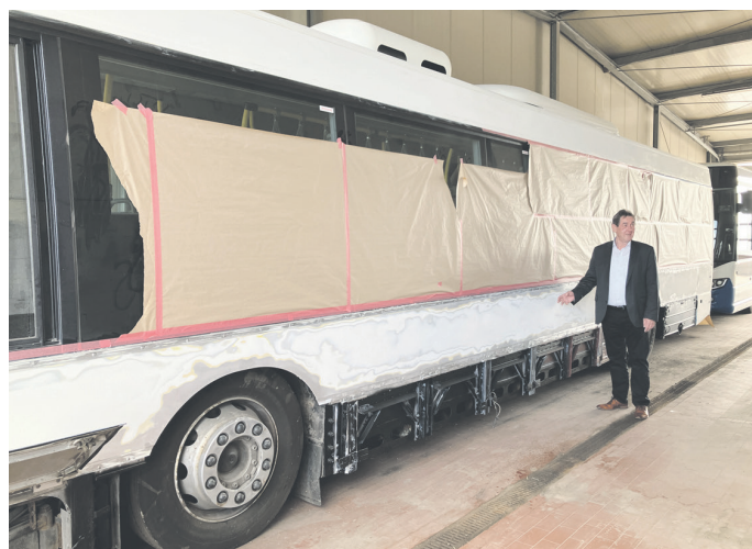
Bereits vorbereitet: Dieser abgeschliffene Bus wird als erstes Fahrzeug in der neuen Kabine lackiert.
